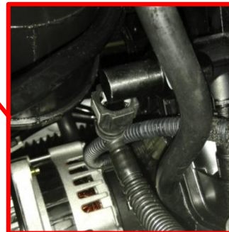
شکل شماره (۲۵) موقعیت نصب گیج فشار ریل سوخت برای خودروی تیب
