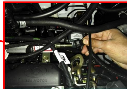
شکل شماره (۲۶) موقعیت نصب گیج فشار ریل سوخت برای خودروی X100
