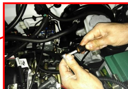
شکل شماره (۲۵) موقعیت نصب گیج فشار ریل سوخت برای خودروی تیب
