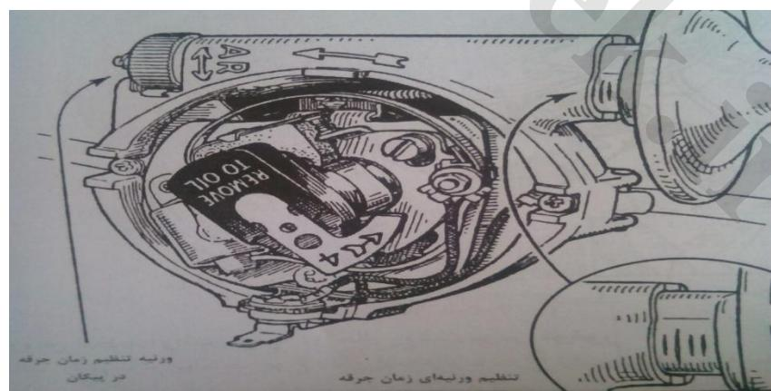
روش اندازه گیری افت ولتاژ در دهانه پلاتین ها
