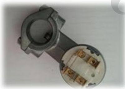
۳. وضعیت برق تجهیزات: با گرداندن بیشتر سوئیچ چراغهای پشت آمپر(روی پانل داشبورد) روشن شده و مسیر جریان برق اکثر تجهیزات الکتریکی برقرار میگردد ACC.
