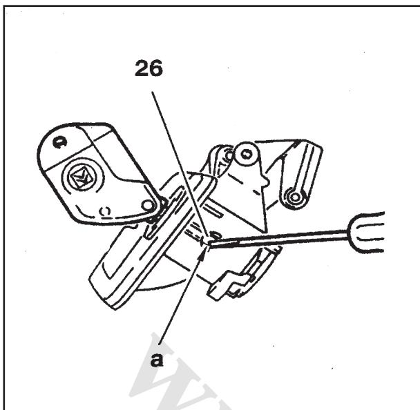
کلید را داخل مغزی قفل قرار داده و لبه یک پیچ گوشته را در شیار "a" قرار دهید.
