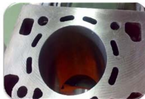
سطح سیلندر فاقد خط و خش و قابل قبول
