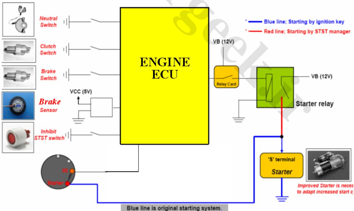
ورودی‌ها و خروجی‌های معمول سامانه خاموش و روشن
