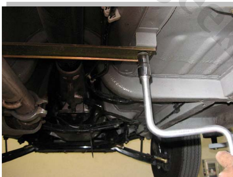
5-14-2-باز کردن پیچ سمت راست محافظ گاردن برای عبور دادن لوله فشار قوی
