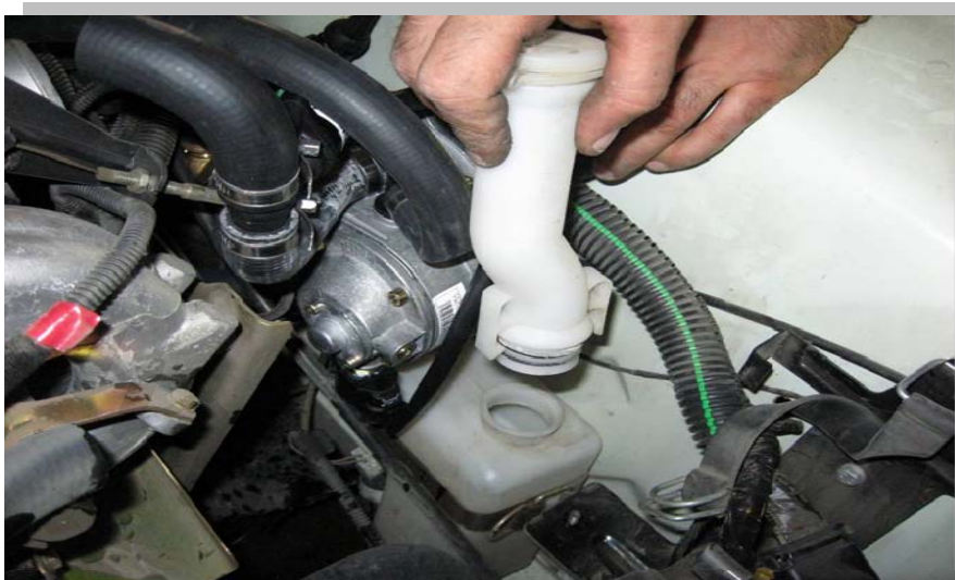
5-7-1- نصب پایه رگولاتور با گشتاور 1 \pm 5 N.M
