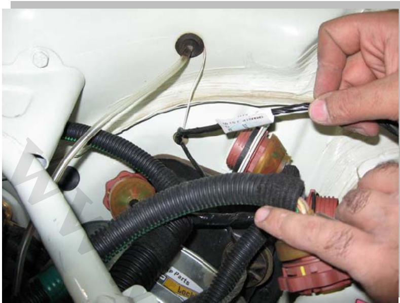
۵-۷-۱- اتصال مادگی فیش جدا شده روی خودرو به نری فیش معادل روی درخت سیم گاز و نصب نری فیش جدا شده روی خودرو به مادگی فیش معادل روی درخت سیم گاز
