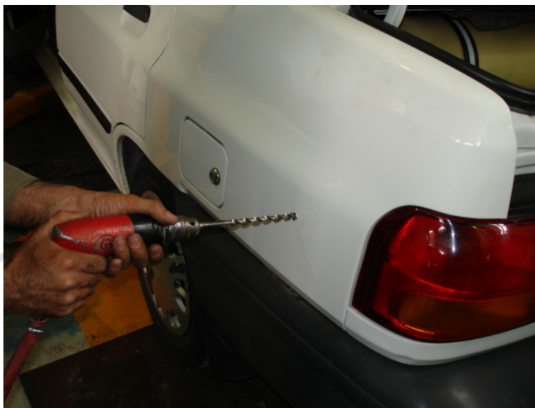
استفاده از دریل برای سوراخ کاری محل قرار گیری مغزی گردبر سمبه ماتریس
