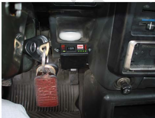
محل نصب کلید انتخاب سوخت
