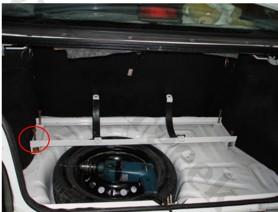
استفاده از پیچ با طول کوتاهتر یا بهره گیری از مهره هرز در مورد یکی از اتصالات پایه مخزن
