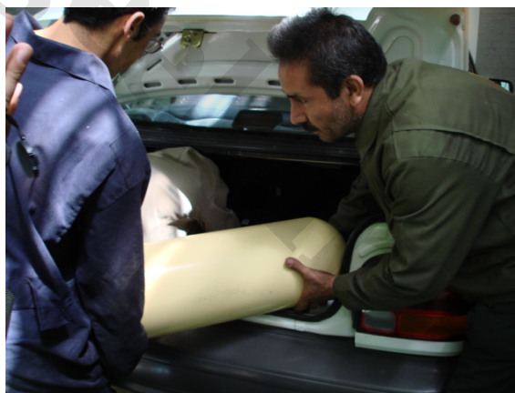
نحوه قراردهی مخزن بر روی پایه
