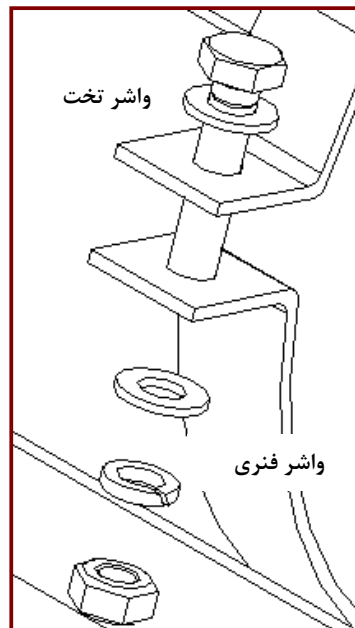
ترتیب قرارگیری واشرهای تخت و فنری قسمت میانی پایه مخزن
