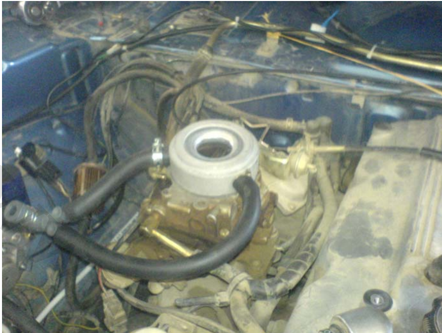
نصب میکسر بر روی دریچه کاربراتور
