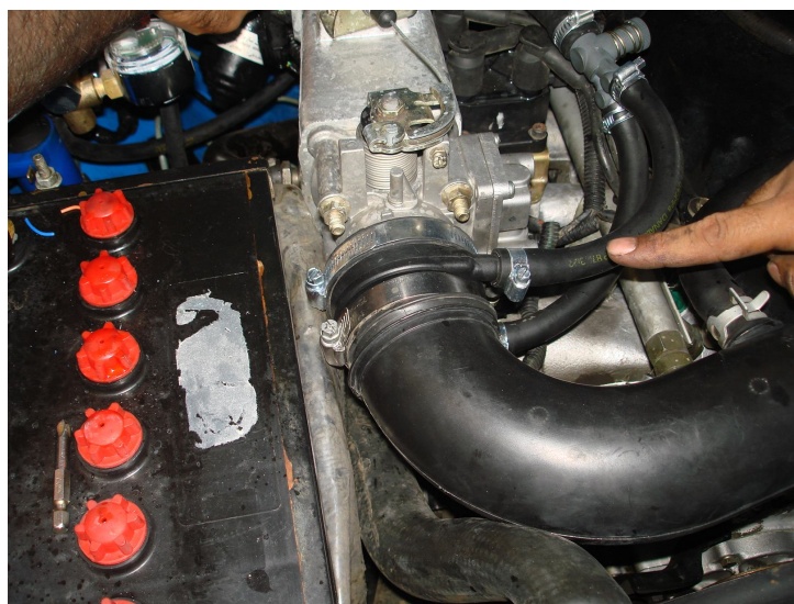
نصب میکسر بر روی دریچه هواکش
