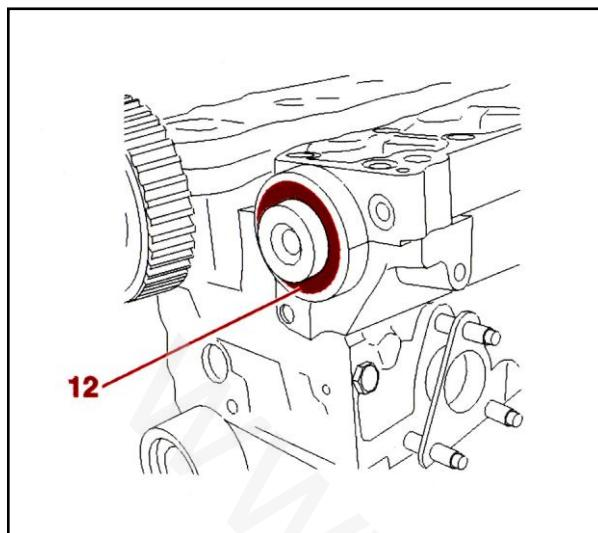
با استفاده از ابزار مخصوص شماره [3] (کد اختصاصی ۲۴۴۱۵۰۱۱)، کاسه نمدهای میل سوپاپ (12) را جا بزنید.
