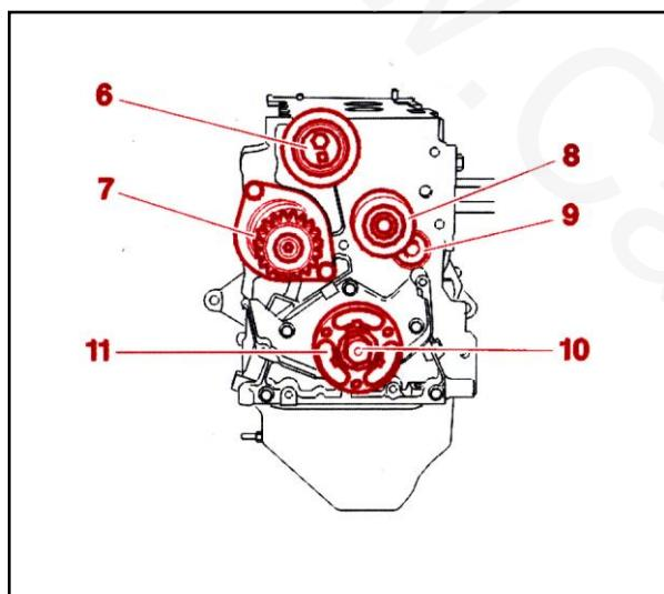
غلتك تسمه سفت کن (6)، واتر پمپ (7)، بلبرینگ تسمه سفت کن (8)، کورکن مجاری روغن (9)، پیچ شماره (10) و چرخنده سر میل لنگ (11) را باز نمایید.
