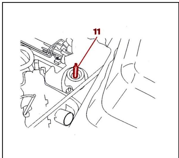
ابتدا پیچ دو سر رزوه متصل کننده گیربکس به دسته موtor سمت چپ را به چسب SPAGRAH آغشته کنید و بر روی گیربکس ، نصب کنید .
