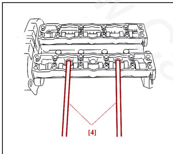
توضیح ابزار مخصوص [4] ( کداختصاصی ۲۴۴۰۸۰۰۸ ) ، به دقت سرسیلندر را کج کرده و جدا نمایید دقت کنید که کاور تایمینگ آسیب نبیند. سرسیلندر و واشر مربوطه را باز نمایید .
