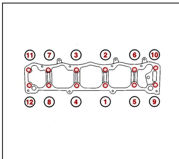
پیچ های سرسیلندر را به ترتیب نمایش داده شده در شکل از ۱ تا ۱۲ بیندید .
