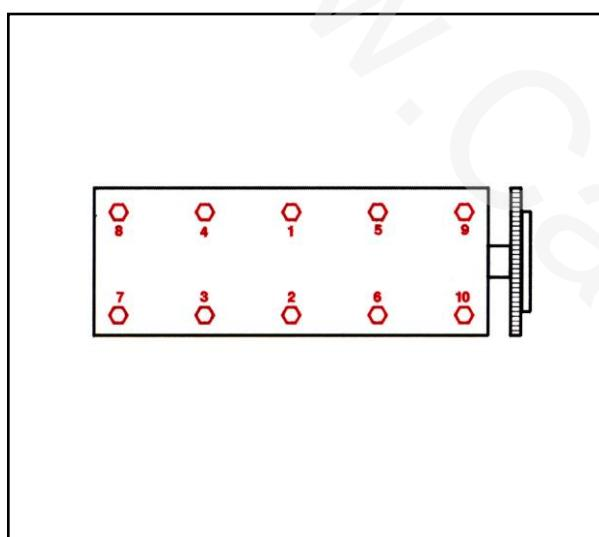
سرسیلندر را در محل خود قرار دهید و پیچ های سرسیلندر را ابتدا به روغن موتور آغشته نمایید و پیچ ها را به ترتیب ارائه شده است ، به روش حلزونی از وسط سرسیلندر به سمت خارج ، محکم کنید و سپس با استفاده از ابزار ذیل - آچار واسط درجه ای (کد اختصاصی ۲۴۴۰۸۰۰۹)-پیچ ها را به اندازه ۲۶۰ درجه محکم نمایید.
