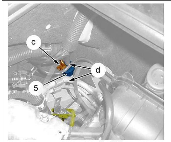
شیلنگ های ورودی و خروجی بخارات بنزین را در نقطه "d" جدا کنید.
