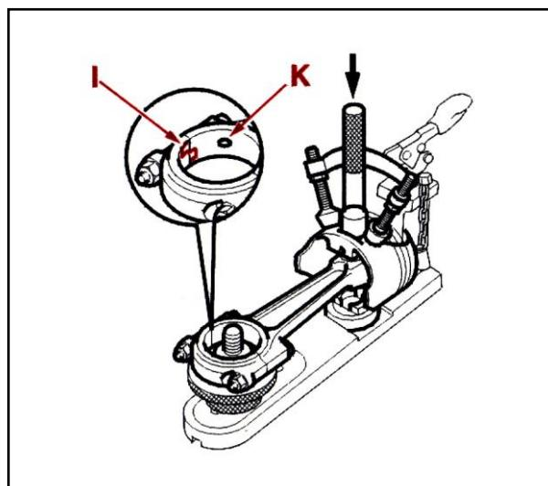
در شاتونهایی که سوراخ روغن برای روغنکاری زیر پیستون در آنها تعییه شده است ، (K) دقت کنید که این سوراخ باید سمت خار یاتاقانها ، قرار گیرند .
