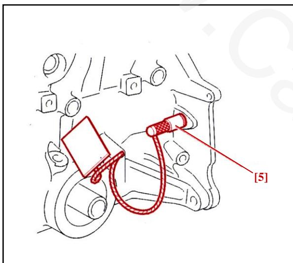
ابزار مخصوص قفل کن فلاپیول [5] (جزء کیت ابزار تعمیر موtor با کد اختصاصی ۲۴۴۱۱۰۷ ) را نصب نمایید.
