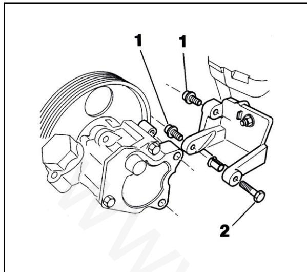
با باز نمودن پیچ های 1 و 2 پمپ هیدرولیک فرمان را بدون باز نمودن لوله های هیدرولیک از موتور جدا کنید . کمپرسور کولر را بدون جدا نمودن لوله های کولر ، از موتور جدا کنید .
