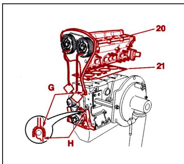
واشر سرسیلندر (21) را نصب نمایید دقت کنید که کلمه Top به سمت بالا باشد سپس سرسیلندر (20) را نصب کنید.
