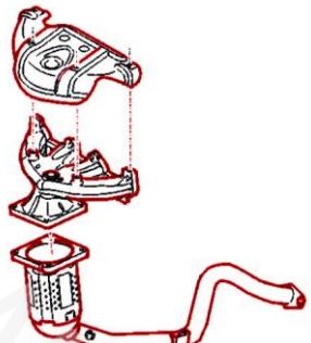
به منظور حفاظت از لوله های هیدرولیک فرمان ، بر روی منیفولد اگزوز ، محافظ حرارت گیر نصب شده است . کاتالیک کانورتور ، مستقیماً به زیر منیفولد اگزوز وصل شده است . برای حفاظت از فیلتر روغن نیز ، یک محافظ حرارت گیر دیگری نصب شده است.
