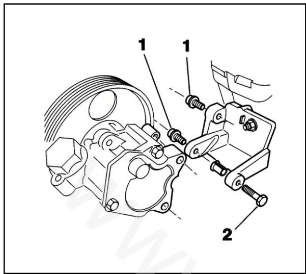
برای نصب پمپ هیدرولیک فرمان ، پیچ های (1) را به میزان ۲/۵ دکانیوتن متر و پیچ (2) را به میزان ۲/۲ دکانیوتن متر محکم کنید .
