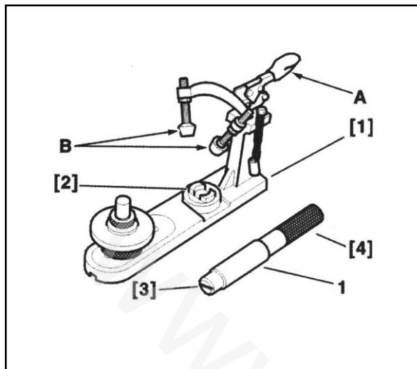
۲- نصب گژین پین درون پیستون
