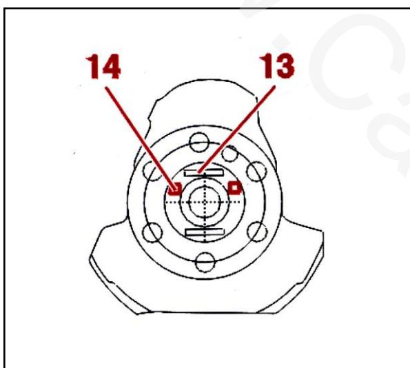
برای انتخاب یاتاقانها ، با استفاده از روش جدولی می بایست از بارکد حک شده بر روی میل لنگ (13) و یا از ضخامت یاتاقان متناسب با هر رنگ حک شده بر روی میل لنگ (14) استفاده نمود .
