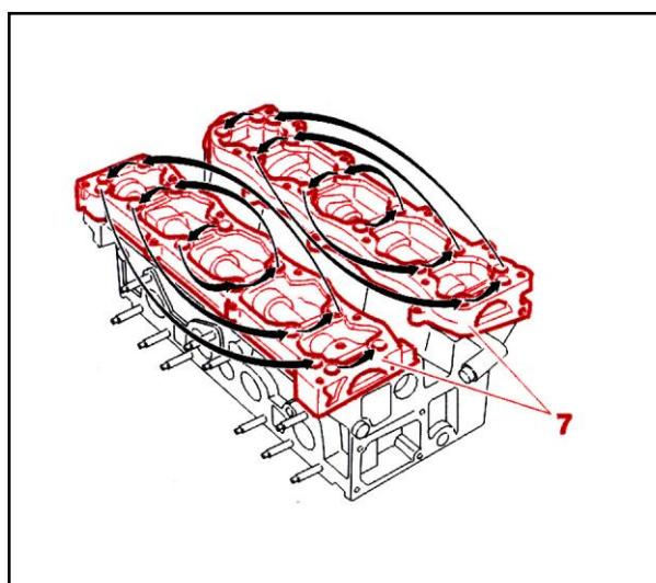
سفت کردن پیچهای کپه میل بادامک ها (7) به ترتیب و
