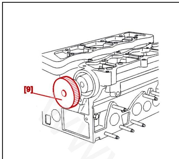
توسط ابزار مخصوص جازن کاسه نمد میل سوپاپ
