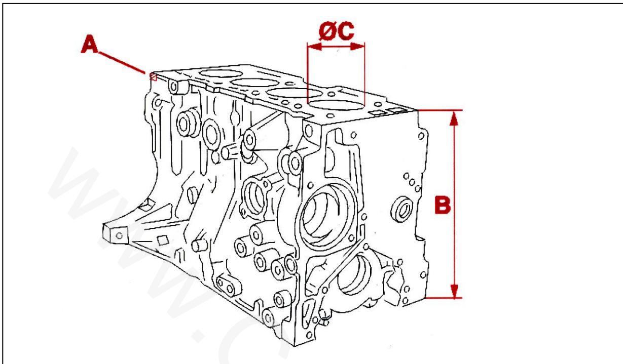
در مدل تعمیری روی بدنه سیلندر (A) علامت R1 حک شده است.
