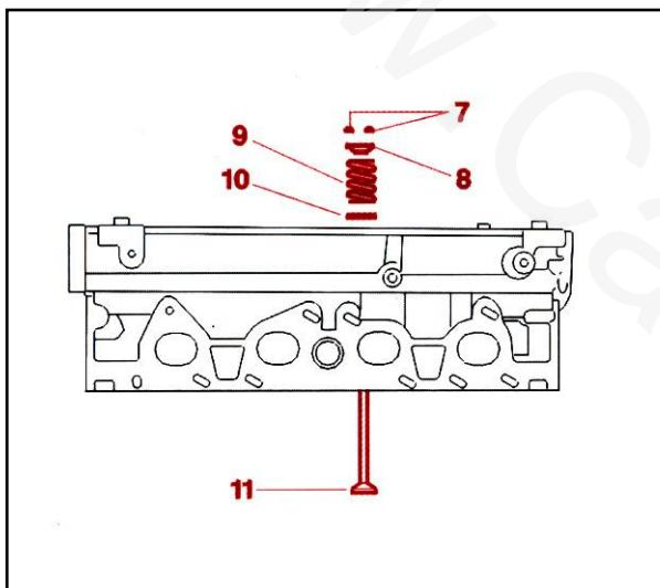
خار موشکی (7)، پولکی (8)، فنر سوپاپ (9)، واشر زیر فنر (10) و سوپاپ (11) را بیرون آورید.
