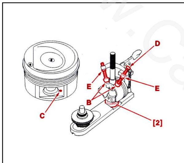
مطابق شکل روبرو ، ابتدا پیستون را بر روی زیر پیستونی [2] (کداختصاصی ۲۴۴۲۴۰۳) قرار دهید و با استفاده از مجموعه جازن [1] (کداختصاصی ۲۴۴۱۲۰۰۴) و دسته جازن گژین پین [4] (کداختصاصی ۲۴۴۱۲۰۰۸) و جازن گزن پین [3] (کداختصاصی ۲۴۴۱۲۰۰۹) پیستون را در محل خود تنظیم کنید . با استفاده از پیچ های تنظیم (E) و محکم نمودن گیره (A) و ثابت نمودن آن با پین (D) ، پیستون را در محل خود ثابت کنید . در زمان قرار دادن پیستون دقت کنید که خار (C) رو به بالا باشد .
