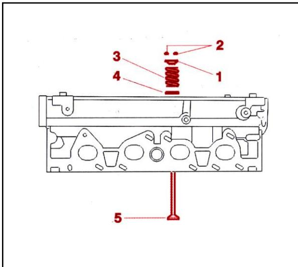
توسط ابزار مخصوص [7] (سوپاپ جمع کن با کد اختصاصی ۱۳۰۱۶۴۴۲) ، سوپاپ(5) ، واشر زیر فنر سوپاپ (4) ، فنر سوپاپ (3) ، پولکی (1) و خار موشکی (2) را نصب نمایید .
