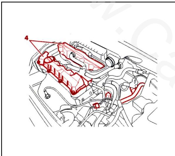
کویل را باز کنید و قالپاق سوپاپها (4) را باز کنید. دقت کنید که پیچ های سرسیلندر را بطور حلقه ای از سمت بیرون به داخل ، باز کنید . با ثابت نگه داشتن میل سوپاپ توسط یک آچار تخت در نقطه A ، پیچ دنده میل سوپاپ را باز کنید .
