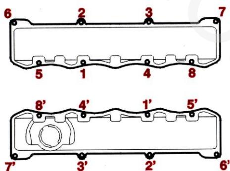
قالپاق سوپاپ را با واشر نو مطابق ترتیب بستن پیچها در شکل سفت کنید . (گشتاور سفت کردن ۰/۷ دکانیوتن متر می باشد)
