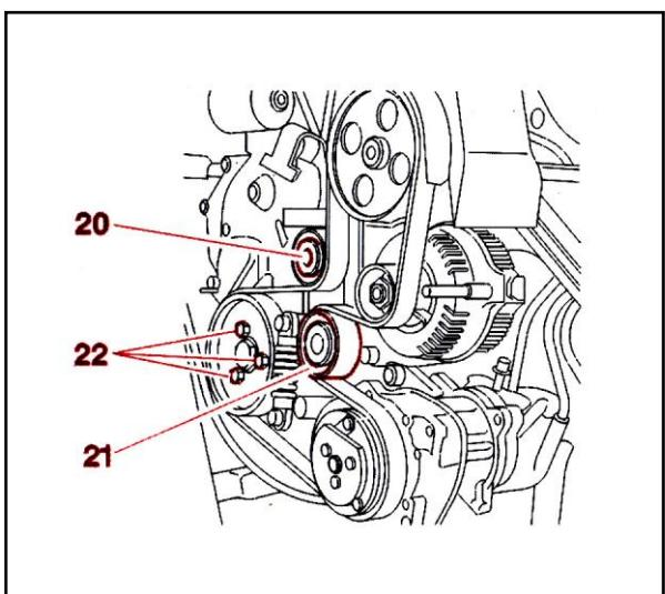
در مدل های که مجهز به کولر می باشند ، تسمه دینام از روی پولی دینام ، پمپ هیدرولیک ، کمپرسور کولر و پولی میل لنگ عبور می کند .
