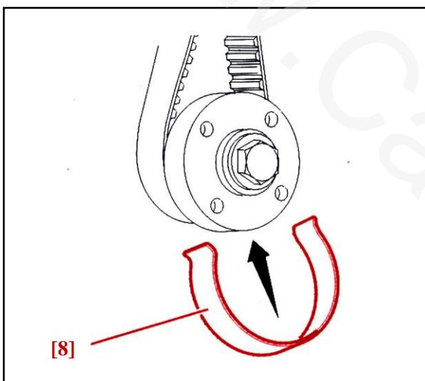
ابزار مخصوص [8] (کااختصاصی ۲۴۴۲۸۰۰۷) را روی پولی میل لنگ قرار دهید تا تسمه را سرجای خود نگهدارد.
