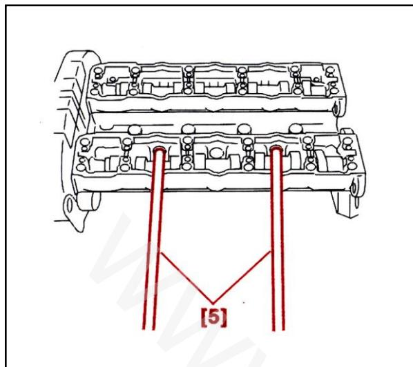
سرسیلندر را با استفاده از ابزار جابجا نمودن سرسیلندر [5] (کد اختصاصی ۲۴۴۰۸۰۸) ، از محل خود جدا نمایید . دقت نمایید که در هنگام برداشتن سرسیلندر ، به قاب تسمه تایم صدمه ای وارد نشود . واشر سرسیلندر را جدا نمایید و محل نشست واشر و سیلندر و سرسیلندر را تمیز نمایید.
