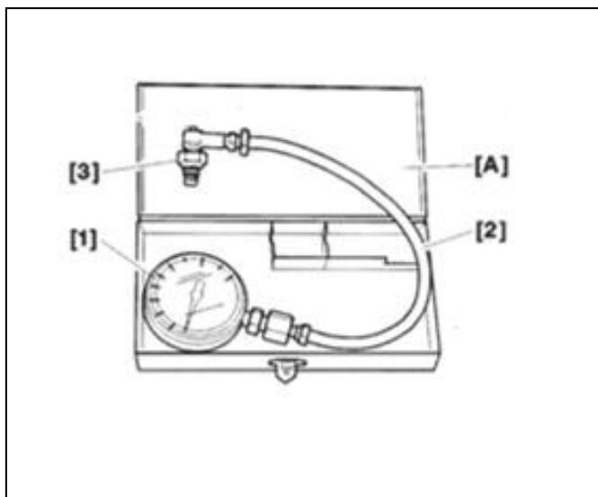
**اندازه گیری فشار روغن**
