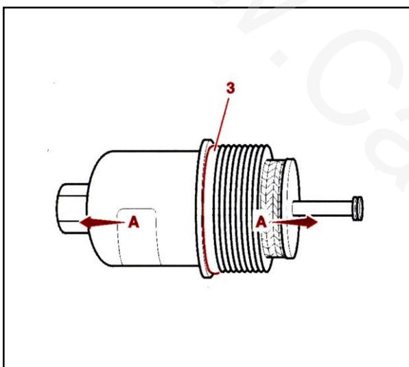
در هنگام تعویض روغن در صورتی که موتور گرم می باشد ، دقت کنید که روغن موجود در فیلتر روغن در هنگام باز نمودن آن به محفظه کاتالیک کانورتور ریخته نشود . (خطر آتش سوزی)
