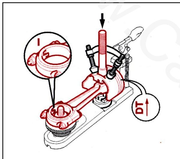
قبل از جاذدن گزین پین آنها را روغن کاری نمایید ، دقت کنید که حروف (DT) روی پیستون به سمت بالا باشد . توجه کنید که خار یاتاقانها (I) در مقابل هم قرار گیرند .
