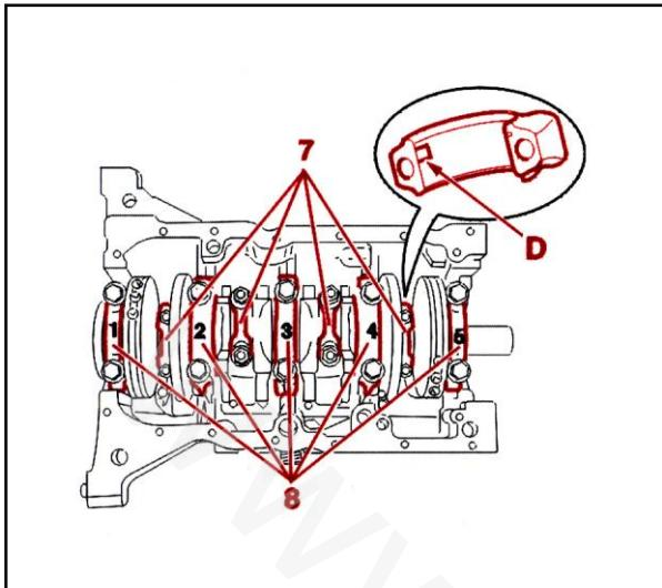
توجه : در موقع جازدن کپه متحرک دقت کنید که شیار یاتاقان (D) کپه متحرک را مقابل شیار یاتاقان روی کپه شاتون قرار گیرد.
