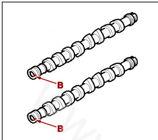
بادامک های میل سوپاپ ها را روغن کاری کنید . میل سوپاپها را در سرسیلندر قرار دهید بطوری که زبانه های آنها (B) در جای خود قرار گیرند .
