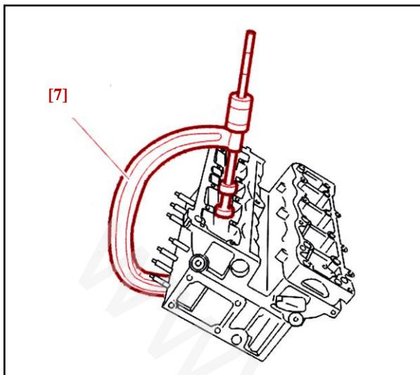
توسط سوپاپ جمع کن [7] (ابزار با کد اختصاصی ۲۴۴۱۶۰۱۳) سوپاپها را خارج نمایید.
