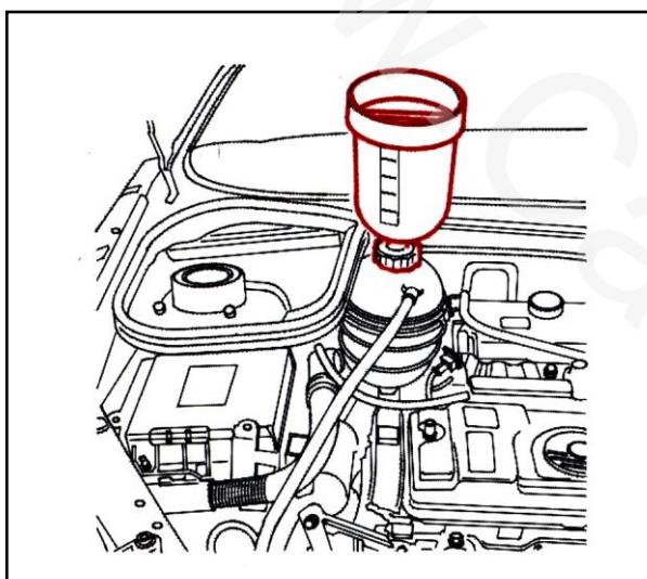
**۳- پرکردن و هوایگیری سیستم خنک کننده**
