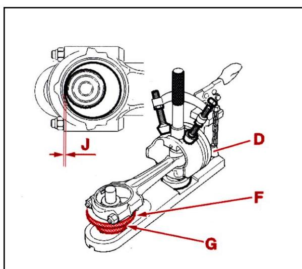
شاتون را بر روی مهره های (G, F) قرار دهید ، شاتون را درون پیستون قرار دهید . مجموعه گژین پین و جازن را برای هم راستا نمودن شاتون در پیستون ، مطابق شکل روبرو استفاده کنید . برای تنظیم ارتفاع شاتون و عمود نمودن آن نسبت به محور گژین پین ، مهره های (F) را بچرخانید . لقی مجاز بین مهره (F) و شاتون (J) معادل ۰/۱ میلیمتر می باشد .
