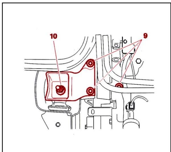
ابتدا ابزارهای [1]، [2] (کداختصاصی ۲۴۴۱۳۰۱۴) را به محل مخصوص بر روی موtor ، متصل کنید و توسط یک جرثقیل موtor را از بالا ، نگه دارید . سپس با باز نمودن پیچ های (9) و (10) دسته موtor سمت راست (سمت گیربکس) که به بدنه متصل می کنند ، را آزاد کنید
