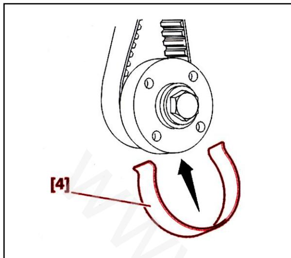
برای ثابت نگهداشتن تسمه تایم بر روی دنده سر میل لنگ از ابزار مخصوص [4] (کد اختصاصی ۲۴۴۲۸۰۰۷) استفاده نمایید.
