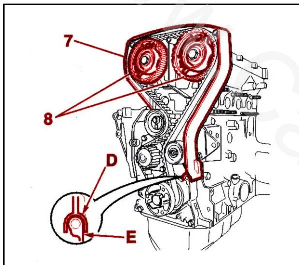
قب تسمه تایم را جا بزنید (7). زبانه (D) قاب تسمه تایم را با شکاف صفحه عایق زیر آن به درستی درگیر کنید. (E) دنده میل سوپاپ را ببندید. (8)
