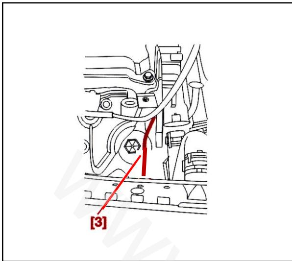
میل لنگ را با استفاده از ابزار مخصوص تایم میل لنگ [3] که در محل خود بر روی فلاپیول ، نصب می شوند، تنظیم کنید . سپس ابزار مخصوص [3] (جزء کیت ابزار با کد اختصاصی ۲۴۴۱۱۰۰۷ ) را خارج کنید و میل لنگ  $\frac{1}{4}$  دور در جهت عکس گردش موتور بچرخانید.
