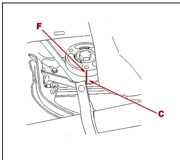
برای نصب تسمه تایم ، علامت (C) روی تسمه را با شیار (F) روی دنده سر میل لنگ ، تنظیم نمایید .
