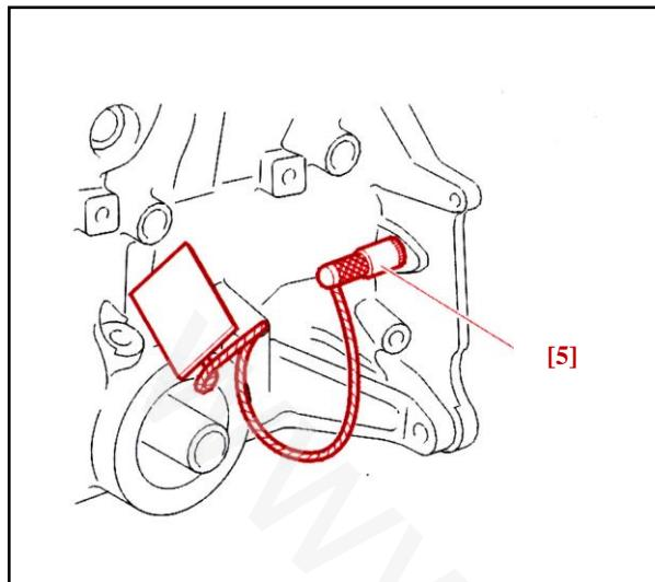
ابزار مخصوص قفل کن فلاپیولی [5] (جزء کیت ابزار تعمیر موtor با کداختصاصلی ۲۴۴۱۱۰۷) را مطابق شکل جا بزنید.
