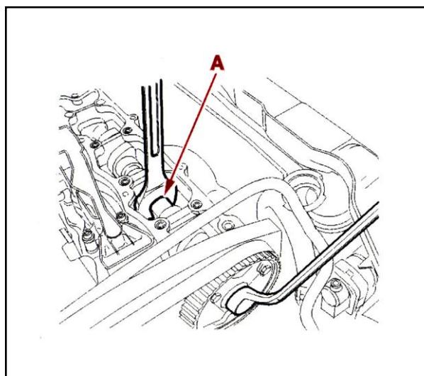
میل سوپاپ را با آچار تخت در نقطه A ثابت نگه داشته و پیچ آن را به اندازه (8) دکانیوتون متر سفت کنید. دقت کنید
