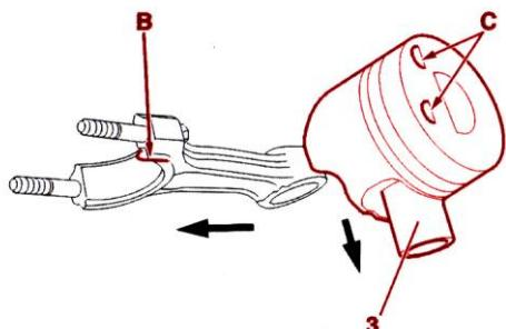
نکته : در زمان جا زدن گزن پین (3) در داخل پیستون در صورت تعویض نشدن قطعات ، آنها را جابجا ننبدید. در زمان تعویض پیستون به نکاتی که در صفحه ۷۴ تا ۷۷ آمده است توجه نمایید.
