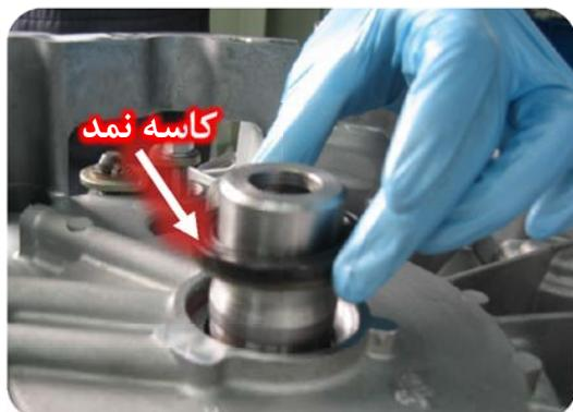
ابتدا ابزار راهنما (۱۰۲۹۷۱) را روی شفت ورودی قرار داده و سپس کاسه نمد را روی آن قرار دهید. ابزار ۱۰۲۹۷۲ را روی ابزار راهنما و کاسه نمد قرار داده و با چکش لاستیکی به آرامی به دسته ابزار ضربه بزنید تا کاسه نمد روی راهنما لغزیده و کاملا در جای خود قرار گیرد. سپس هر دو ابزار را از جای خود خارج کنید.
