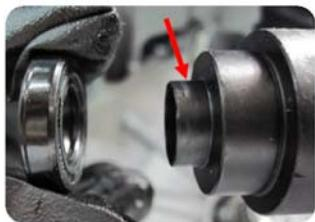
ابتدا لبه نازک ابزار را به اندکی واژلین آغشته نمایید و سپس کاسه نمد جدید را روی آن گذاشته و ابزار را به همراه کاسه نمد روی شافت قرار دهید. به آهستگی با چکش لاستیکی به دسته ابزار ضربه بزنید تا کاسه نمد در جای خود قرار گیرد.
