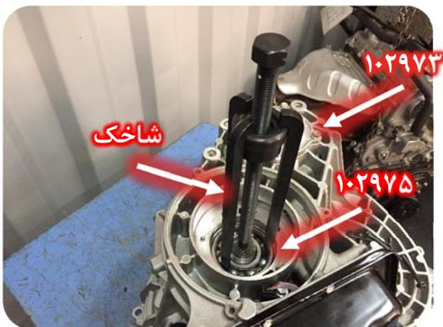
ابتدا گردگیر بلبرینگ را با استفاده از یک پیچ گوشته کوچک جدا کرده و بعد از آن مطابق شکل، قطعه دوم (ابزار ۱۰۲۹۷۵) را در محل مشخص شده نصب نموده و سپس با قرار دادن نوک پیچ فشاری ابزار ۱۰۲۹۷۳ روی آن، شاخکهای ابزار را به نحوی نصب نمایید تا ناخن های ابزار با گنس بلبرینگ درگیر شوند. سپس با استفاده از یک آچار، پیچ بزرگ ابزار را سفت کنید تا ضمن چرخش آن بلبرینگ از جای خود بیرون کشیده شود.
