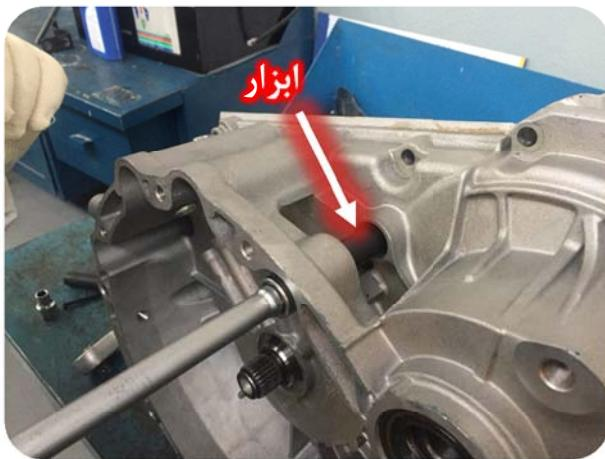
ابتدا اهرم شفت انتخاب وضعیت را خارج نموده و ابزار مخصوص را روی شفت قرار داده به نحوی که شفت وارد سوراخ ابزار شود. با استفاده از آچار بکس، ابزار را بچرخانید تا رزووهای کلگی ابزار به داخل کاسه نمد نفوذ کرده و آن را در بر بگیرد و ابزار در جای خود محکم شود. پیچ کوچک و بلند روی ابزار را به کمک یک آچار مناسب بچرخانید تا کاسه نمد مستعمل از جای خود حرکت کرده و نهایتاً خارج شود.
