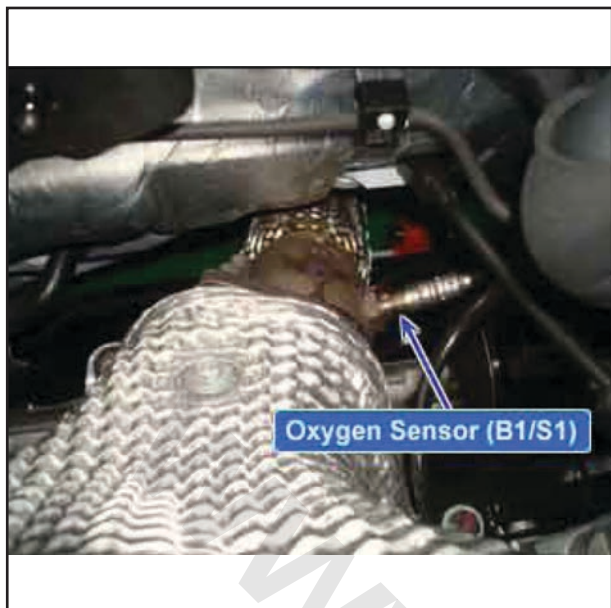
P۰۱۳۳ کُندی پاسخ مدار سنسور اکسیژن بالادست (ردیف ۱ / سنسور ۱) موقعیت سنسور اکسیژن بالادست
