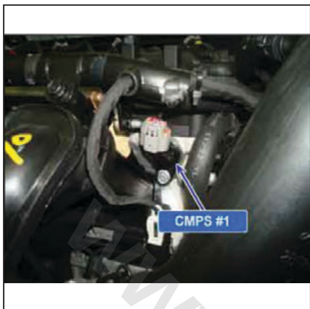
P۰۳۴۱ بازه / عملکرد مدار سنسور موقعیت میل بادامک A (ردیف ۱) موقعیت قطعه
