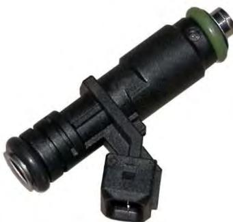
هنگامی که جریان الکتریکی به انژکتور می رسد سولنوئید، دریچه (پاشش) را باز کرده و در اثر اختلاف فشار بین لوله سوخت رسانی در منیفولد هوای سوخت به صورت پودر شده و به پشت سوپاپ هوا پاشیده می شود. طول زمان تزریق توسط واحد کنترل الکترونیکی تعیین می گردد. هنگامی که به هر کدام از انژکتورها ولتاژ ارسال می گردد سوزن انژکتور به سمت بالا حرکت کرده و بدین ترتیب مسیر ورودی بنزین به سیلندر را باز می کند. با قطع جریان، سوزن انژکتور توسط نیروی فنر به جای خود بر می گردد و نازل بسته می شود.
