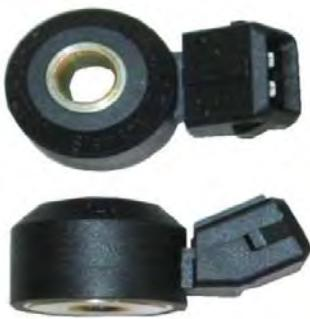
اطلاعات مربوط به میزان ناک در داخل موتور توسط سنسور ناک (کوبش) اندازه گیری شده و به واحد کنترل الکترونیک انتقال می یابد. ناک، پدیده‌ای ارتعاشی است که در اثر احتراق زود هنگام مخلوط سوخت و هوا در داخل سیلندر موتور ایجاد می گردد. در صورت ایجاد این پدیده در داخل سیلندر موتور واحد کنترل الکترونیک با استفاده از اطلاعات دریافتی از سنسور ناک، میزان آوانس موتور را کاهش داده و همزمان با آن نسبت سوخت به هوا را افزایش می دهد.
