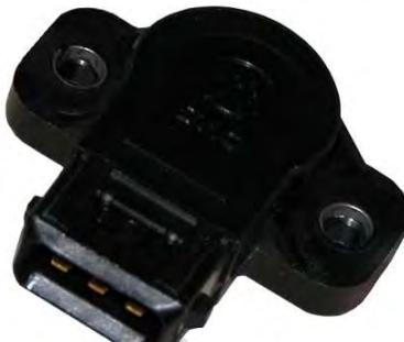
این پتانسیومتر، موقعیت لحظه‌ای دریچه گاز را به منظور تشخیص وضعیت‌های دور آرام، تمام بار و یا وضعیت‌های مربوط به شتاب گیری یا کاهش سرعت خودرو به واحد کنترل الکترونیک ECU ارسال می‌نماید. ولتاژ تغذیه این سنسور، ۵ ولتی است و توسط ECU تامین می‌شود.
