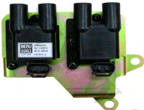
کویل، جهت تامین ولتاژ جرقه زنی در شمع ها مورد استفاده قرار می گیرد و شامل دو کویل مجزا است که از طریق چهار وایر به شمع ها متصل شده اند. در این سیستم، جرقه زنی بطور همزمان در سیلندرهای ۱-۴ و
