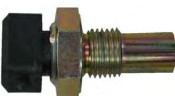
این سنسور دمای مایع سیستم خنک کاری را اندازه گیری و به واحد کنترل الکترونیک ارسال می نماید. این سنسور از نوع مقاومت NTC بوده و دارای کانکتور دو پایه است.
