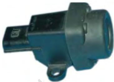
سوئیچ ثقلی و یا سوئیچ قطع اضطراری جریان سوخت بر روی سینی جلوی پا (دیواره آتش-Fire wall) در خودرو که کمترین ارتعاشات را دارد نصب شده است. این سوئیچ در تصادفات شدید و یا در زمان واژگونی خودرو به ECU سیگنالی ارسال می کند و با توجه به این سیگنال، عملگرهای اصلی مانند مدار پمپ بنزین، انزکتورها و کویل را غیر فعال می کند. در خودروهای مجهز به پمپ بنزین برقی، عدم قطع جریان برق به پمپ در زمان تصادف و یا واژگونی خودرو می تواند سبب بروز آتش سوزی در خودرو گردد.
