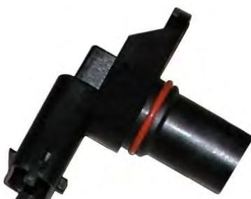
وظیفه این سنسور تعیین موقعیت TDC و یا نقطه مرگ بالای سیلندر ۱ و تفکیک آن از موقعیت اندازه گیری شده توسط سنسور دور موتور است.
