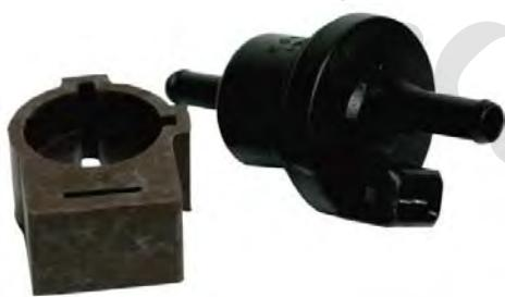
با استفاده از شیر برقی کنیستر که به وسیله واحد کنترل الکترونیک، کنترل می شود امکان بازیافت بخارات بنزین جذب شده از باک در داخل کنیستر، فراهم می گردد.
