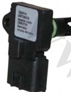
ولتاژ بازگشته از سنسور متناسب با تغییر فشار اندازه گیری شده توسط پیزوالکتریک موجود در این سنسور (مقاومت متغیر با فشار) تغییر می کند.
