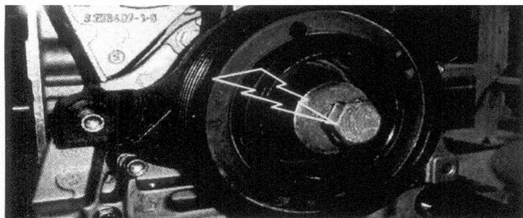
۴- سنبه نگهداری پولی میل لنگ را در محل خود جا زده و موقتا به وسیله آچار دستی با پیچ دارای بوش تا گشتاور (Nm) ۲۰-۳۰ محکم نمائید.
