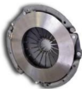
شکل 1-5 فنر دیافراگمی و نمونه ای از کلاچ دیافراگمی
