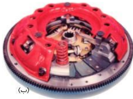
شکل 1-4 (الف) اجزا یک کلاچ تک صفحه ای (ب) نمونه یک کلاچ تک صفحه ای با فنر فشاری
