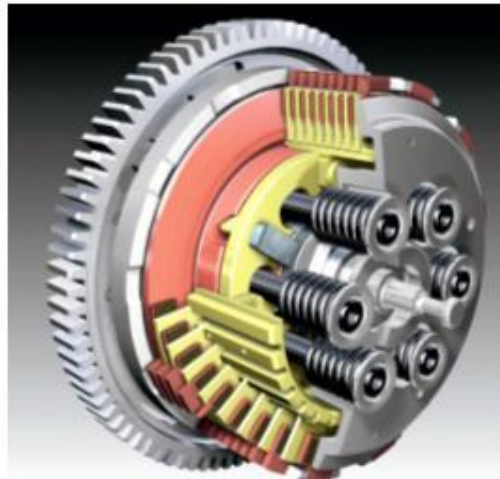
شکل 1-7 نمونه ای از کلاچ چند صفحه ای
