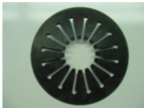
شکل 1-5 فنر دیافراگمی و نمونه ای از کلاچ دیافراگمی
