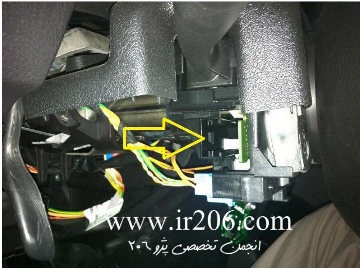
شکاف کروز مشخصه و به صورت ریل مانند دسته کروز رو تا انتهای جا بزنید به شکل زیر:
